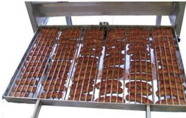
E' provvisto di un capiente vassoio scaldavande nella parte superiore e di una pratica vasca per la raccolta del grasso di cottura nel fondo.
